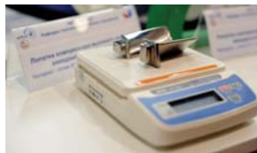
Лопатки турбины низкого давления из разработанного на кафедре ТЛП сплава алюминиды титана предназначены для авиационного двигателя. Они в два раза легче, чем используемый сегодня аналог на основе никеля.
