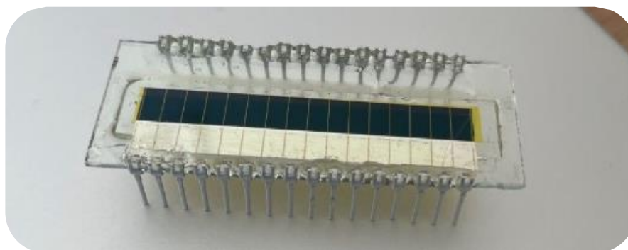
Рис.3. Детектор рентгеновского излучения на базе перовскитного светодиода.
