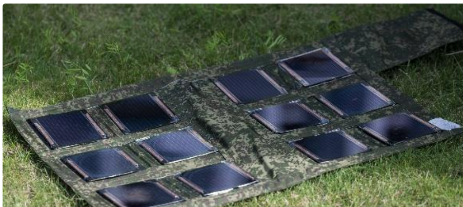
Рис.2. Прототип раскладываемой перовскитной солнечной батареи.
