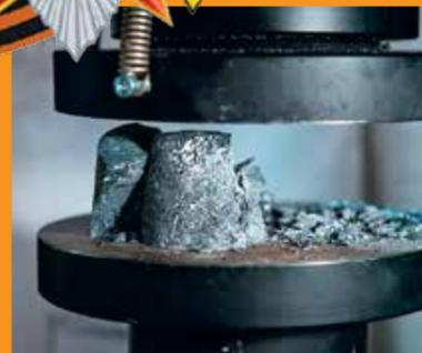
Студенты 5 курса специальности «Физические процессы горного или нефтегазового производства» на лабораторной работе по курсу «Механическое разрушение горных пород» исследуют разрушение образцов горных пород с Новой Земли.
