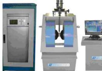
**Вибромагнитомер VSM-250 фирмы LDJ, Китай**
