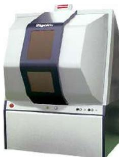
Дифрактометр Rigaku SmartLab, Rigaku
