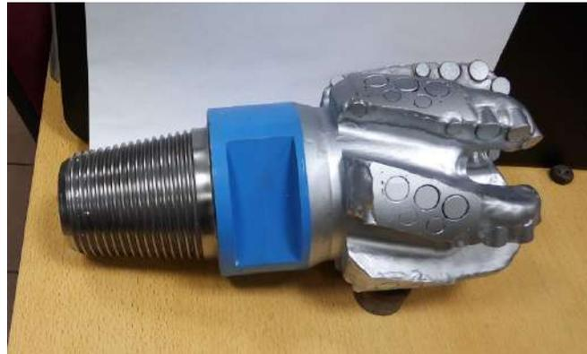
**Рис. 2. Долото Ø142,9 мм для горизонтального и наклонного бурения на нефть и газ с алмазно-твердосплавными режущими элементами**
