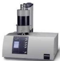
Синхронный термоанализатор Netzsch STA 449 F3
