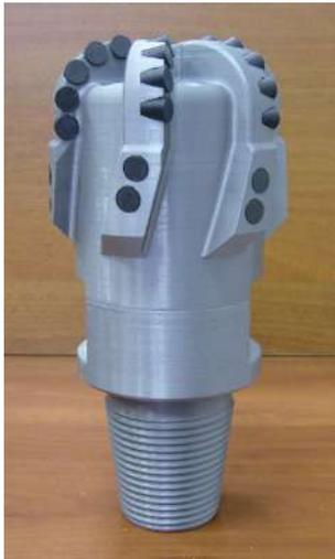
**Рис. 1. 3-D модель бурового долота в натуральную величину**
