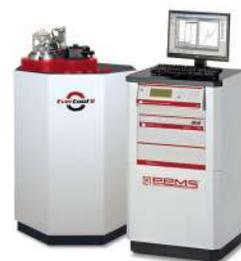
Измерительный комплекс PPMS-9 + EverCool-II Cryogen-Free
