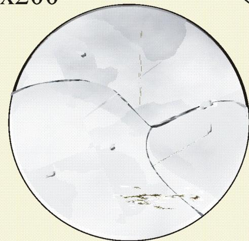
Жидкость изменяет химический состав от X до а,  $\alpha$ -фаза изменяет свой химический состав от б до X.
