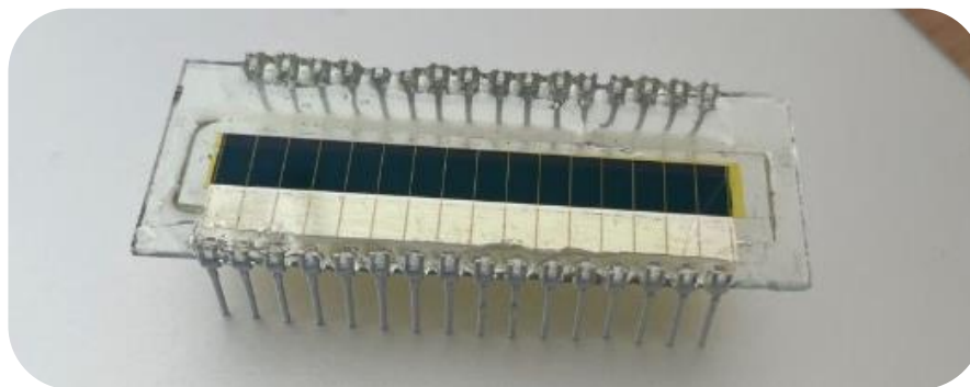
Рис.3. Детектор рентгеновского излучения на базе перовскитного светодиода.
