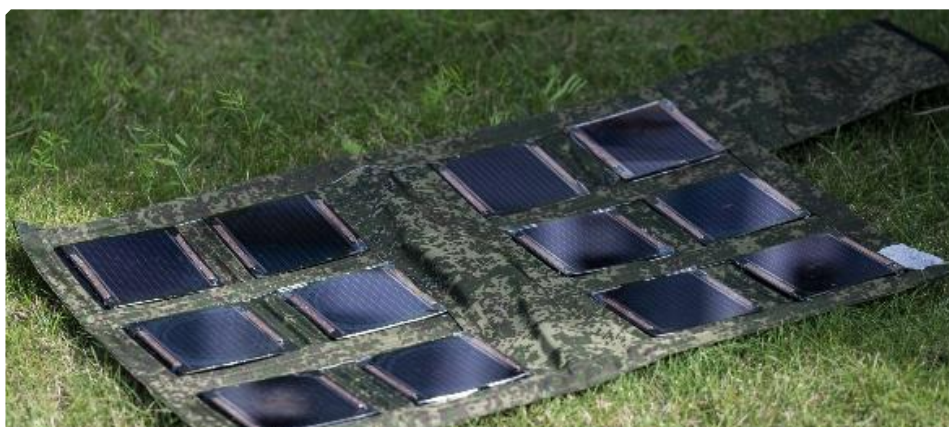
Рис.2. Прототип раскладываемой перовскитной солнечной батареи.
