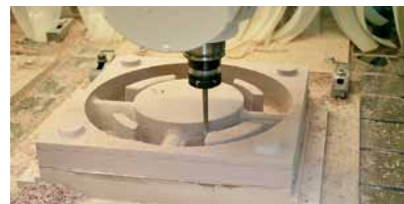
Изготовление элемента оснастки для отливки «Корпус опоры»
