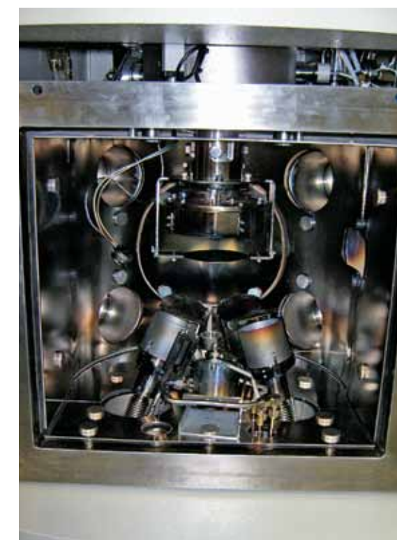
Ростовая установка для получения наноградиентных и электрооптических покрытий
