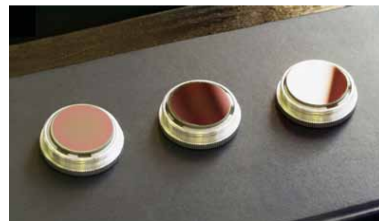
Образцы с наноградиентными покрытиями Ta_2O_5 - SiO_2 на кварцевой подложке
