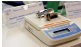
Лопатки турбины низкого давления из разработанного на кафедре ТЛП сплава алюминиды титана предназначены для авиационного двигателя. Они в два раза легче, чем используемый сегодня аналог на основе никеля.
