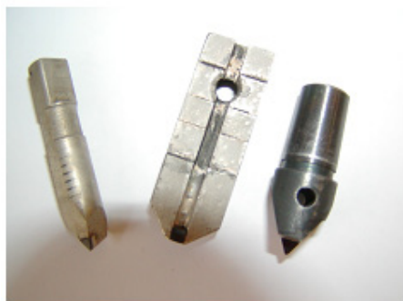
Рис. 1. Прецизионный правящий инструмент
