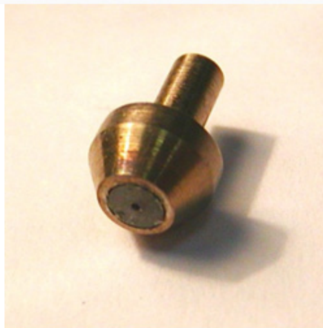
Рис.2. Алмазные струеформирующие сопла.
