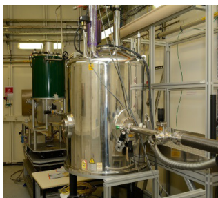
Экспериментальный комплекс для проведения измерений XMCD в сильных магнитных полях
