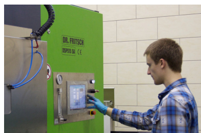
Инженер НОЦ аспирант Андрей Усенко синтезирует образцы методом искрового плазменного спекания
