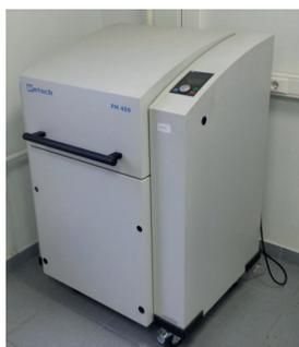
Высокоэнергетическая шаровая планетарная мельница **Retsch PM 400**
