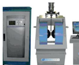
Вибромагнитометр **VSM-250** фирмы LDJ, Китай
