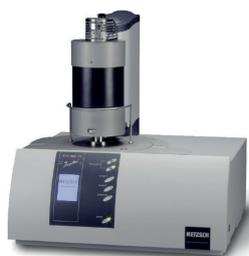
Синхронный термоанализатор **Netzsch STA 449 F3**
