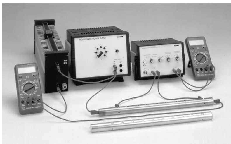
Рис. 11.6. Общий вид экспериментальной установки для определения коэффициента электропроводности.
