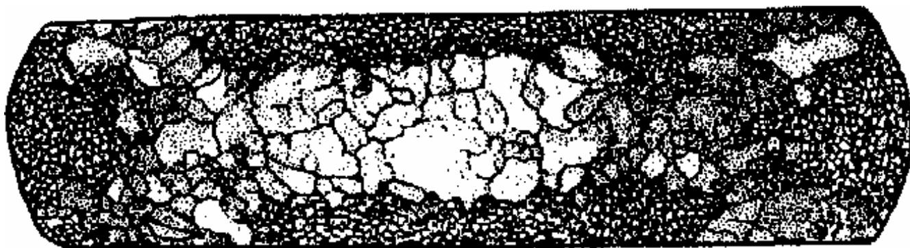
Рисунок 2.5 – Зоны деформации в поперечном сечении цилиндрической осаженной заготовки после собирательной рекристаллизации
