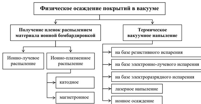
Рисунок 1 – Классификация способов физического осаждения покрытий в вакууме
