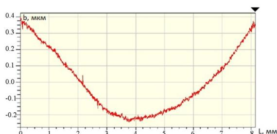
Рисунок 12 – Типичный вид профилограммы композита «подложка-основа», сформированного при напылении покрытий (Ti,Al)N-Cu и (Ti,Al)N-Cu на твердосплавную основу
