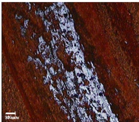
Рисунок 30 – Фотография области износа покрытия (Ti,Al)-Ni 12%(ат.)
