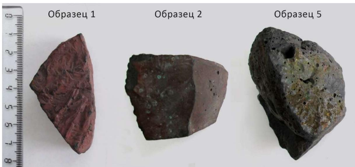
Рисунок 12 — Внешний вид некоторых образцов исследованного шлака
