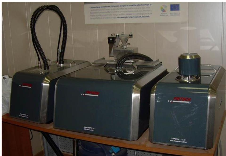
Рисунок 2.3 Лазерный анализатор частиц Fritsch Analysette 22 microtec plus (FRITSCH, ФРГ).
