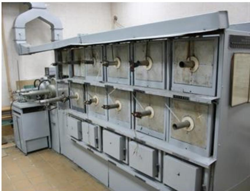
Рисунок 2.5. Стенд лабораторных трубчатых печей с вытяжкой
