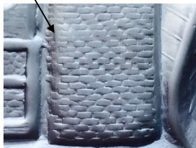
Рисунок 5.33 – Модельная деталь со сложным рельефом, полученная методом сверхпластической формовки из разработанного сплава
