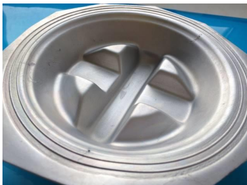
Рисунок 5.32 – Модельные детали, полученные методом сверхпластической формовки: модель «крест» (а), модель «купол» (б)
