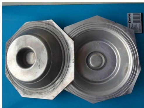
Рисунок 5.32 – Модельные детали, полученные методом сверхпластической формовки: модель «крест» (а), модель «купол» (б)
