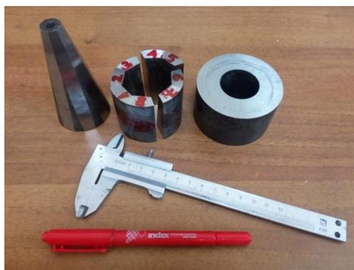
Рисунок 3.2 – Изготовленный инструмент для физического моделирования процесса экспандирования
