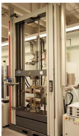
Рисунок 3.7 – Испытательная машина Zwick Roell 200кН
