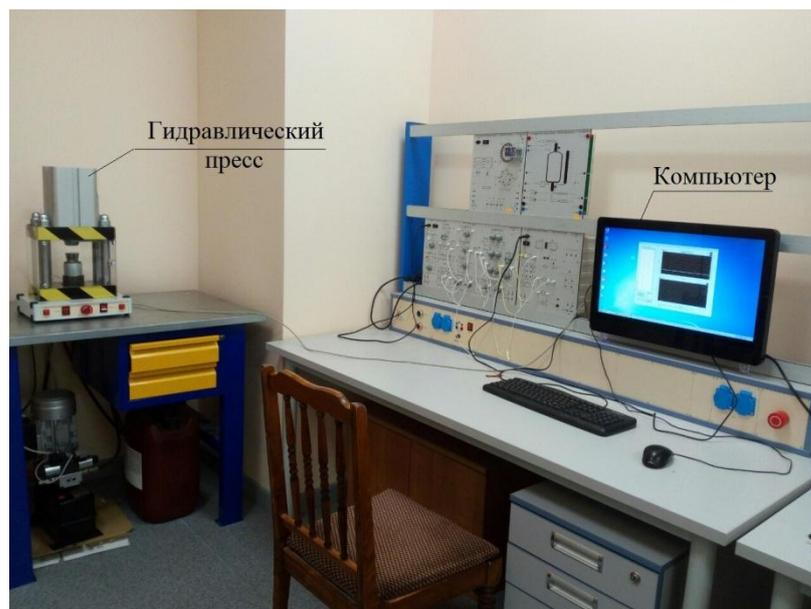
Рисунок 3.8 – Комплектность гидравлического пресса ОМД–3
