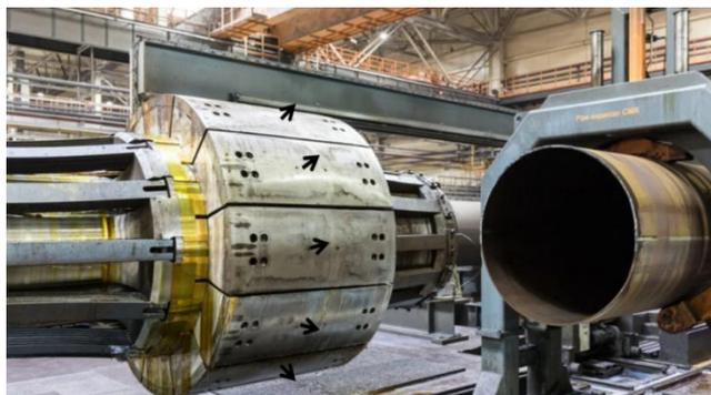
Рисунок 1.9 – Схема процесса экспандирования ТБД
