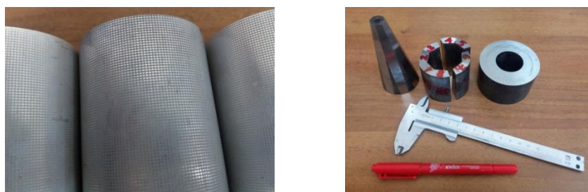
Рисунок 8 – Трубные заготовки после лазерной гравировки (а) и изготовленный инструмент (б) для физического моделирования
