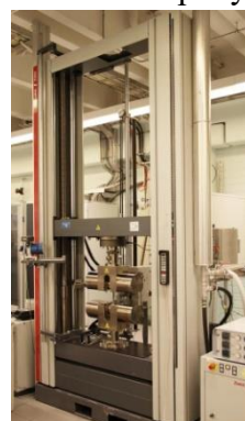
Рисунок 7 – Кривая сопротивления деформации сплава АД31 (а) при растяжении на испытательной машине Zwick Roell 200кН (б)
