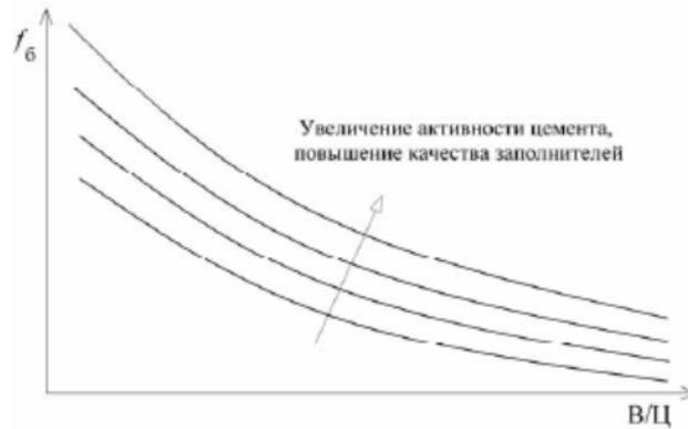
Рисунок 1.9 – Зависимость прочности бетонов  $f_b$  от водоцементного отношения
