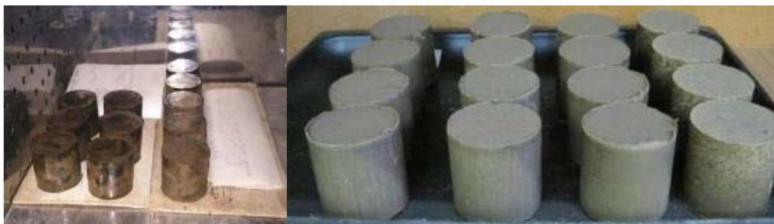
Рисунок 6.4 – Внешний вид шлакогрунтовых цилиндров
