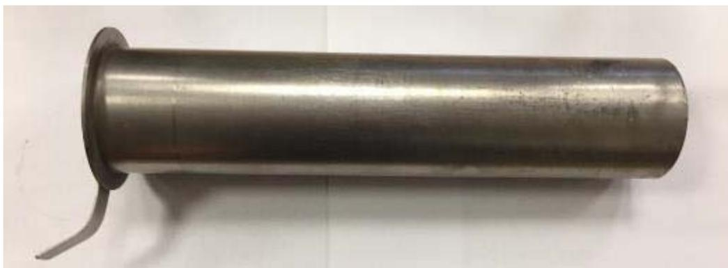
Рисунок 2.3 – Реактора аппарата ВЭГ–80
