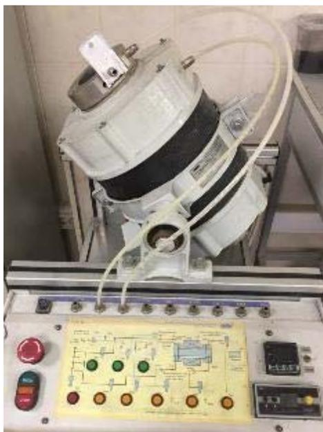
Рисунок 2.2 – Вихревой электромагнитный гомогенизатор ВЭГ–80
