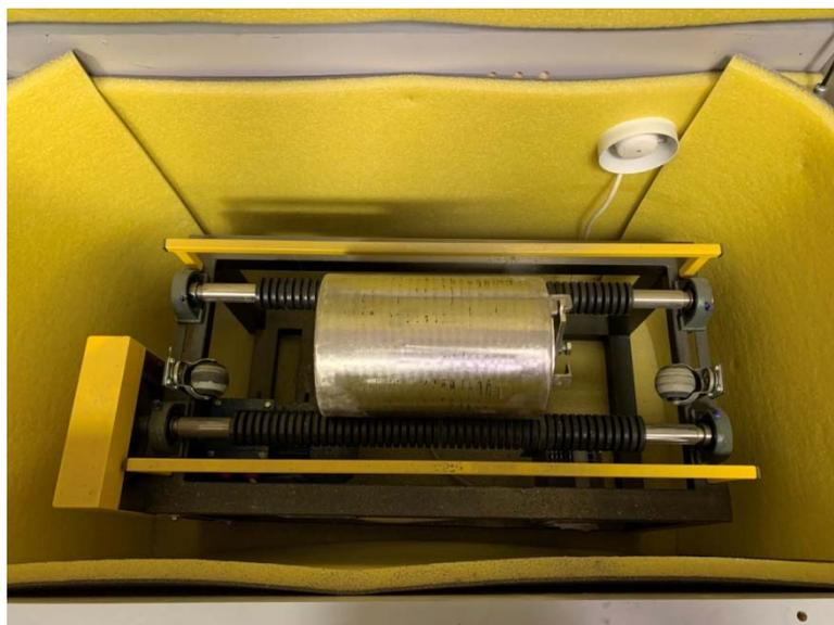
Рисунок 2.1 – Шаровая лабораторная мельница МШЛ-1
