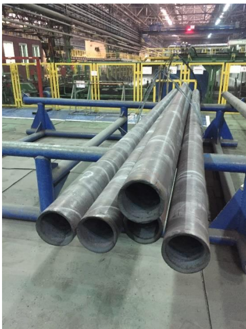
Рисунок 39 – Трубы размером 166,0x16,9 мм, полученные в результате экспериментальной прокатки:
