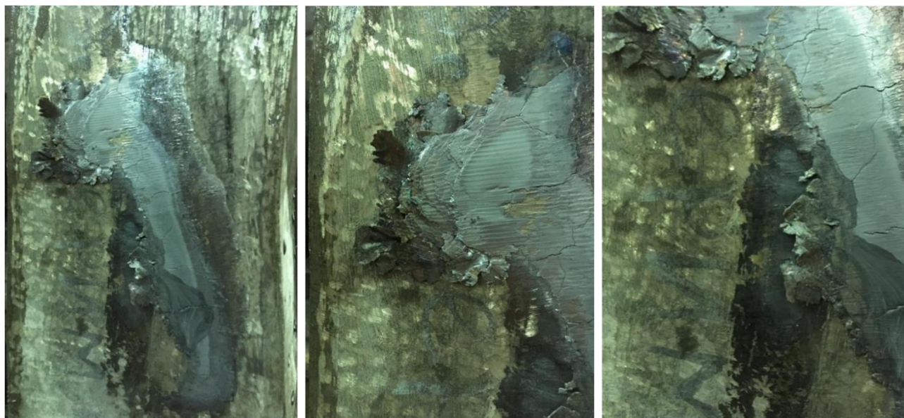
Рисунок 8 – Налипание прокатываемого металла на рабочую поверхность линейек
