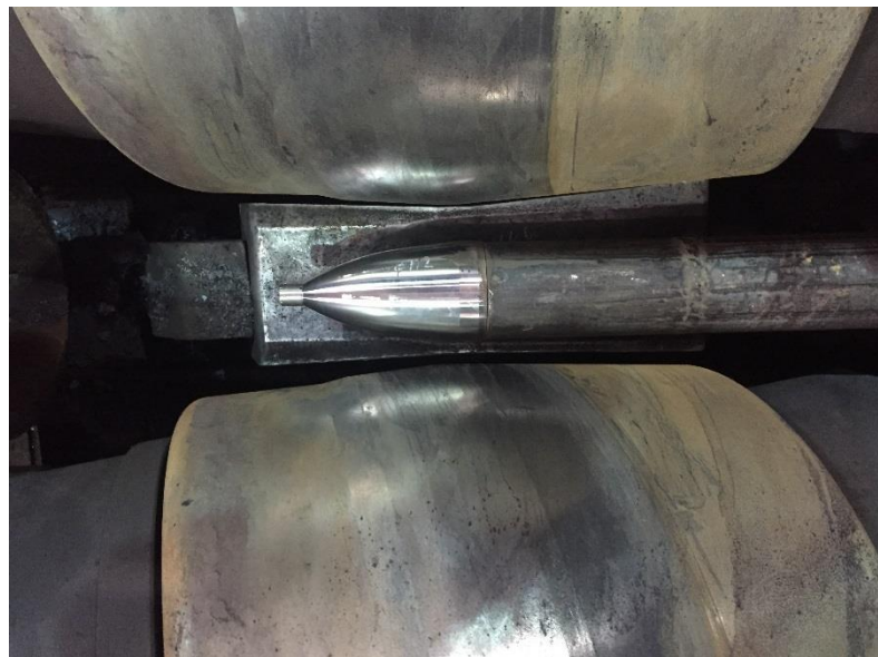
Рисунок 40 – Фото очага деформации, перед прокаткой труб размером 187,7x17,0 мм.
