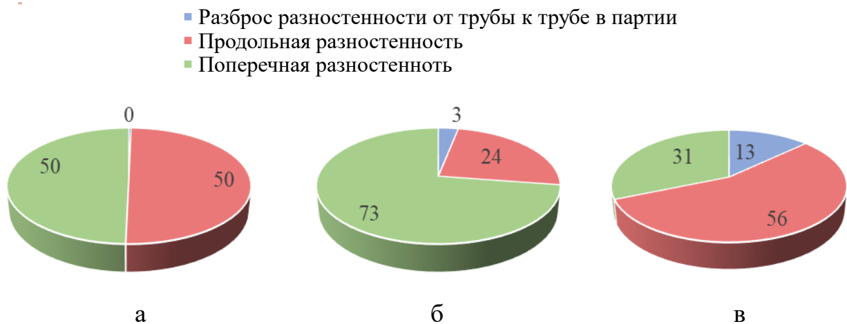
Рисунок 21 – Вклад составляющих в общую разностенность труб, %:
