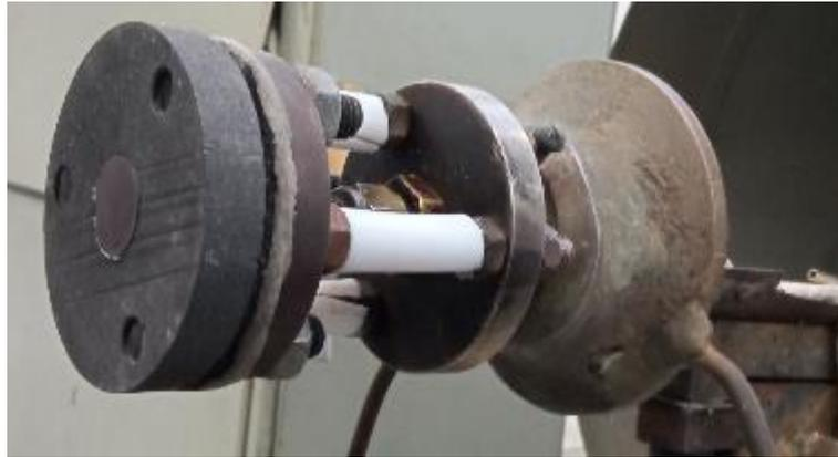
Рисунок 2.19 – Фотография образца в державке
