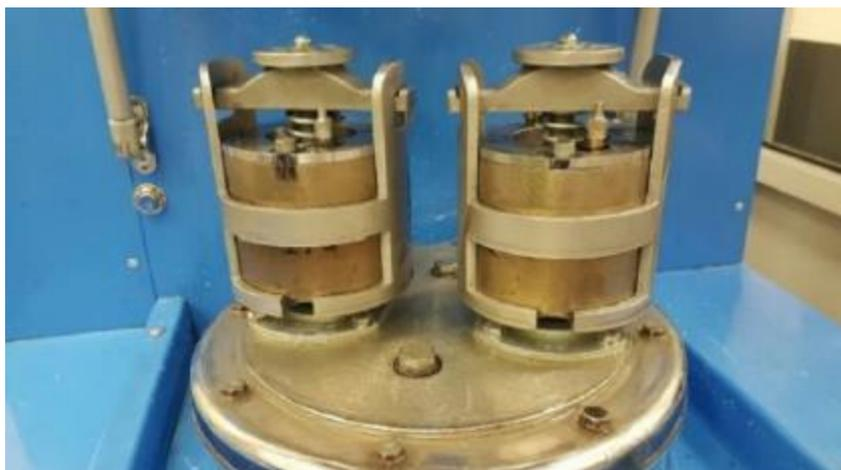
Рисунок 2.2 – Высокоэнергетическая планетарная шаровая мельница Активатор – 2S
