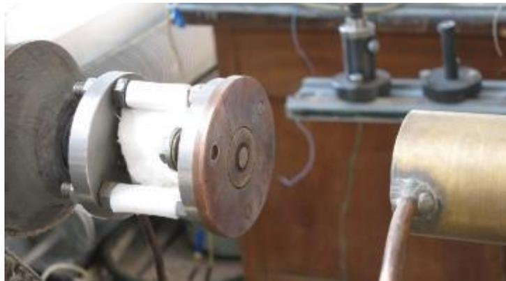
Рисунок 2.20 – Датчик теплового потока
