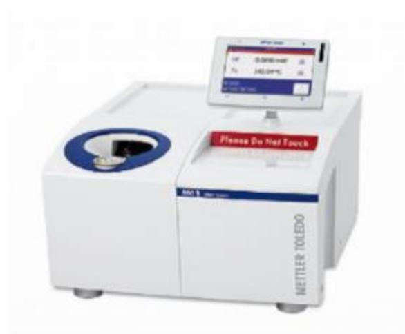
Рисунок 2.13 – Дифференциальный сканирующий калориметр Mettler Toledo DSC 3 (Mettler Toledo, Швейцария)
