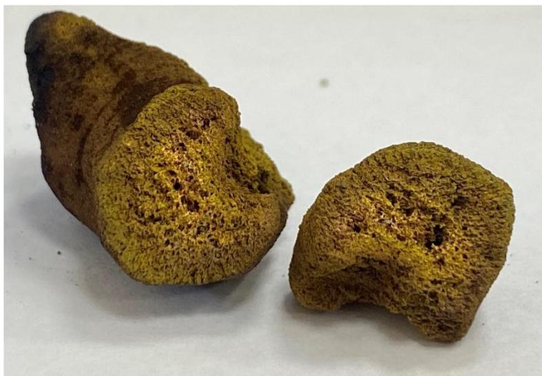
Рисунок 3.6 – Фотография сечения образца из механоактивированной смеси после горения в атмосфере азота
