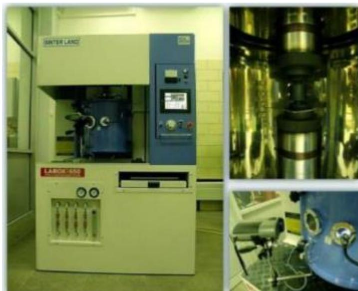
Рисунок 2.4 – Установка искрового плазменного спекания Spark Plasma Sintering – Labox 650
