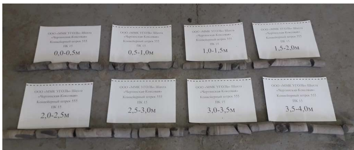
Рис. 3.4. Керны пород кровли конвейерного штреха № 555, ПК15 ООО «ММК УГОЛЬ «Шахта «Чертинская-Коксовая»
