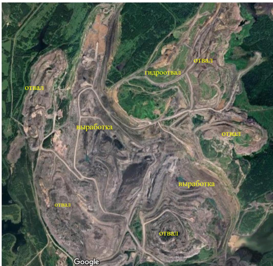
Рисунок 1.4 – Расположение отвальных насыпей относительно выработок на примере разреза «Кедровский» (АО «УК «Кузбассразрезуголь»)
