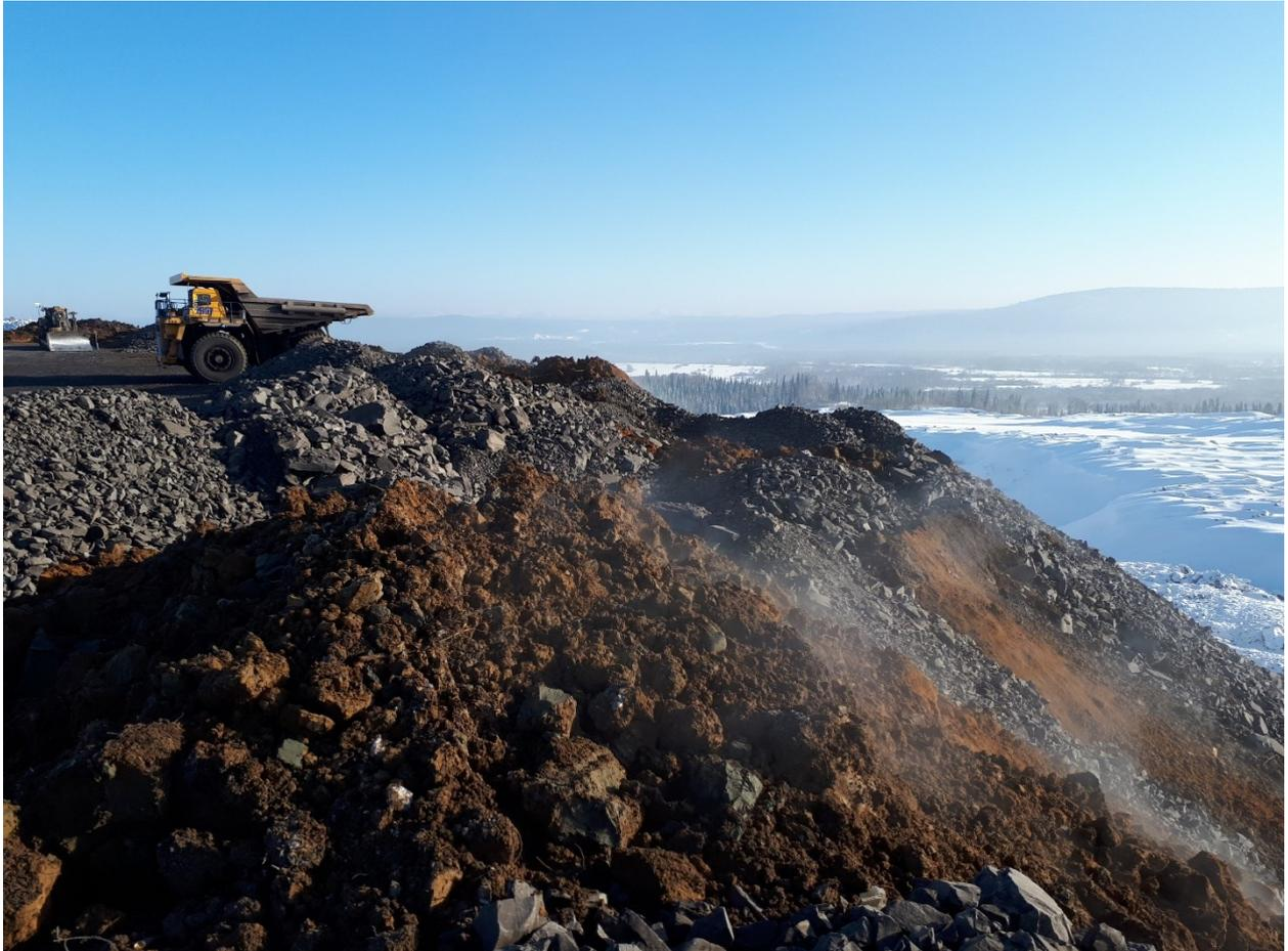
Рисунок 4.1 – Формирование отвала «Южный», совместная укладка алевролитов и песчаников с глинистыми породами
