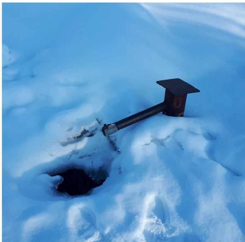
Рисунок 4.7 – Самоизлив подземных вод из мониторинговой гидрогеологической скважины №6, расположенной в пойме р. Ерунаковка
