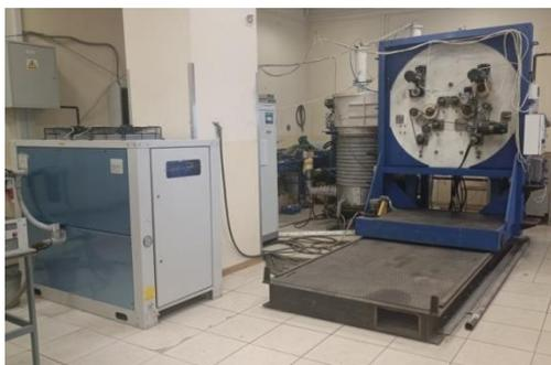
Рисунок 4.2 – Установка вакуумной металлизации Бусофита
