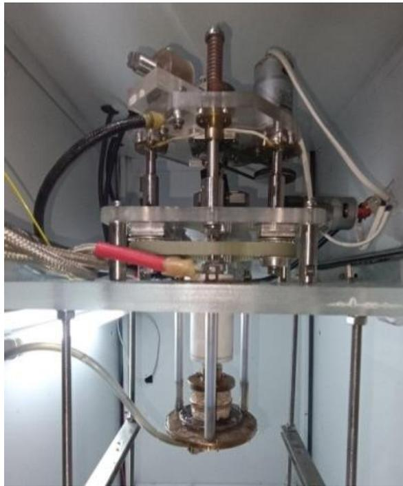
Рисунок 4.5 – Электроимпульсная установка получения наночастиц металлов
