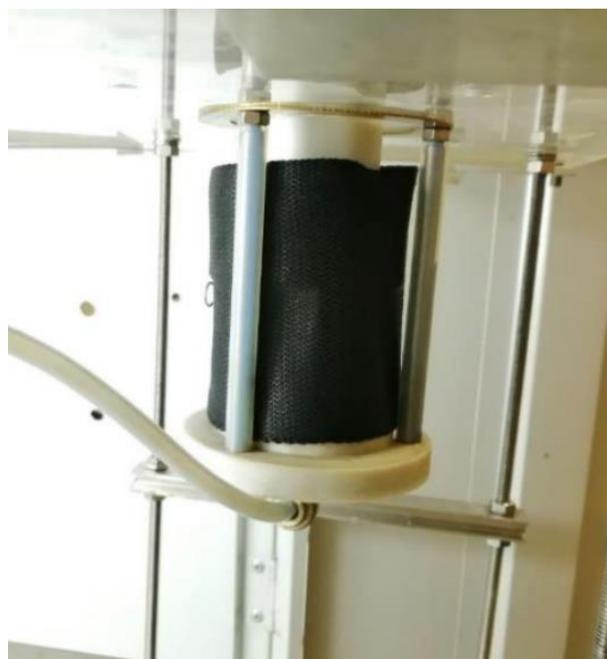
Рисунок 4.8 – Оснастка для крепления обрабатываемого материала Бусофит в электроимпульсной установке
