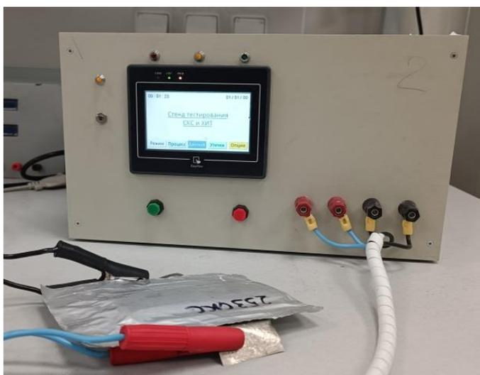
Рисунок 4.27 – Лабораторный стенд для исследовательских многоциклических испытаний параметров изготовленных экспериментальных образцов ЭСК-2.21
