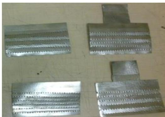
Рисунок 4.15 – Готовые токосъемники из титановой фольги
