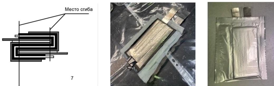
Рисунок 4.22 – Конструкция ячейки «гармошка»:
