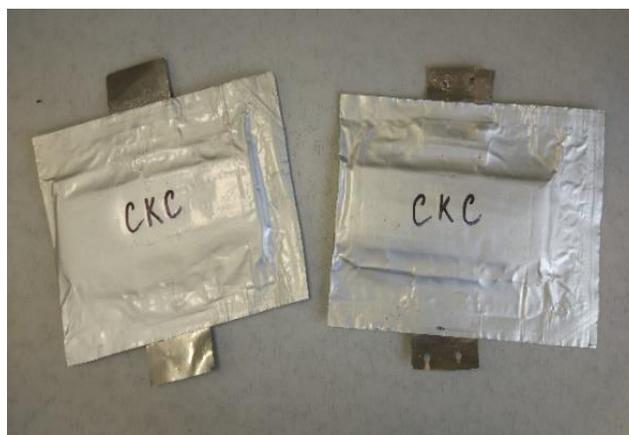
Рисунок 4.25 – Изготовленные ячейки
