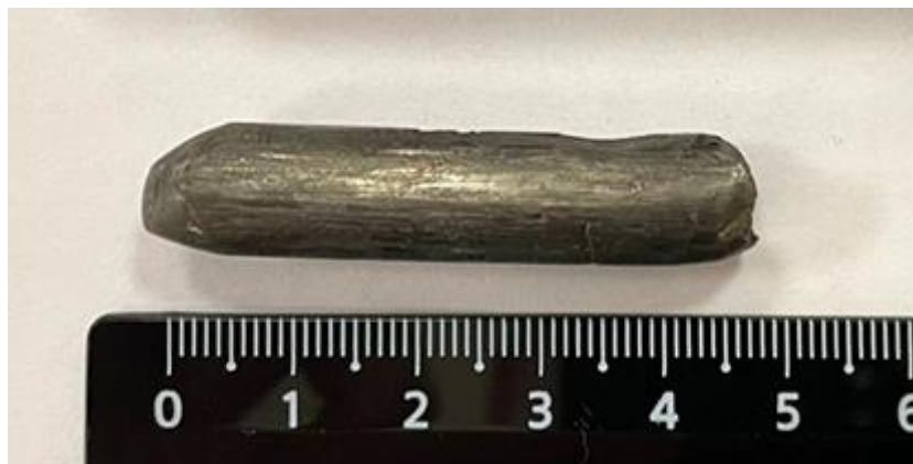
Рисунок 20 – Общий вид заготовки после РКУП на оснастке диаметром 10 мм
