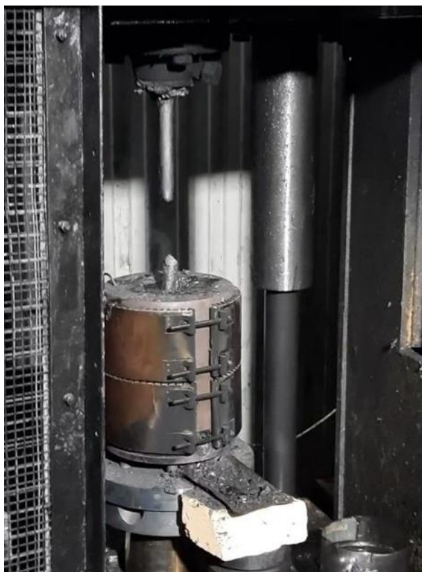
Рисунок 21 – Общий вид пресса с оснасткой для реализации РКУП
