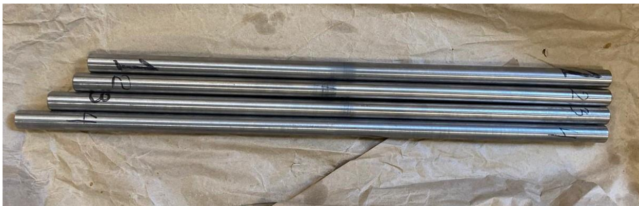
Рисунок 19 – Внешний вид прутков после обточки
