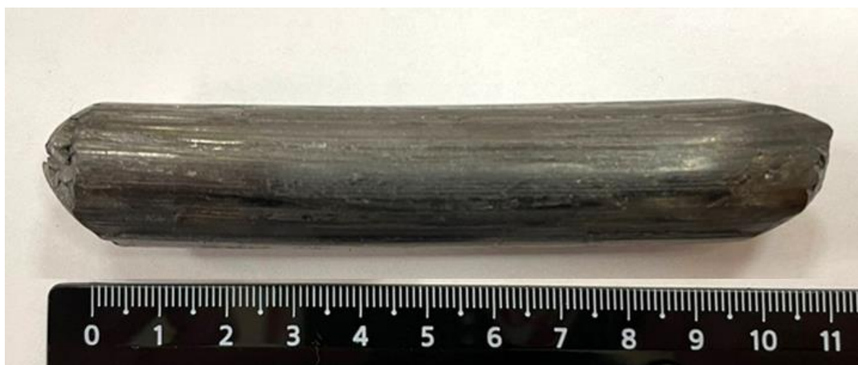
Рисунок 23 – Общий вид заготовки после РКУП на оснастке диаметром 20 мм
