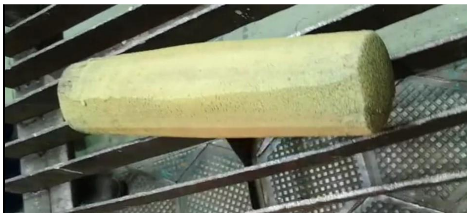
Рисунок 18 – Внешний вид кованных заготовок после сбивания граней на круг
