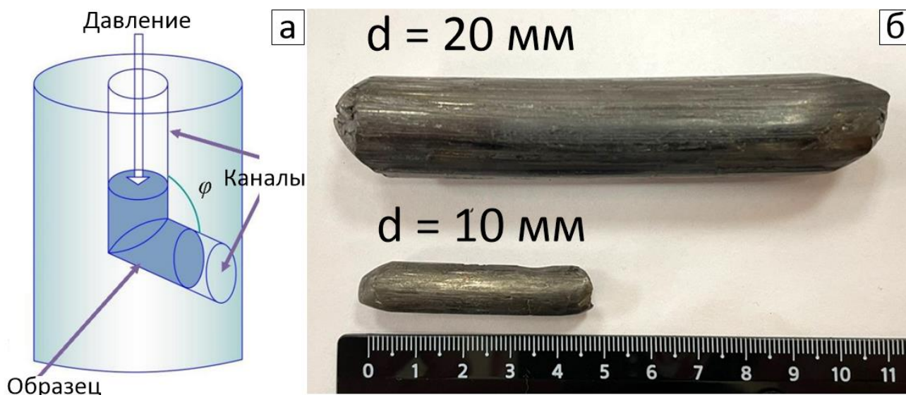
Рисунок 1 – общий вид образцов после РКУП (а); схема РКУП (б)
