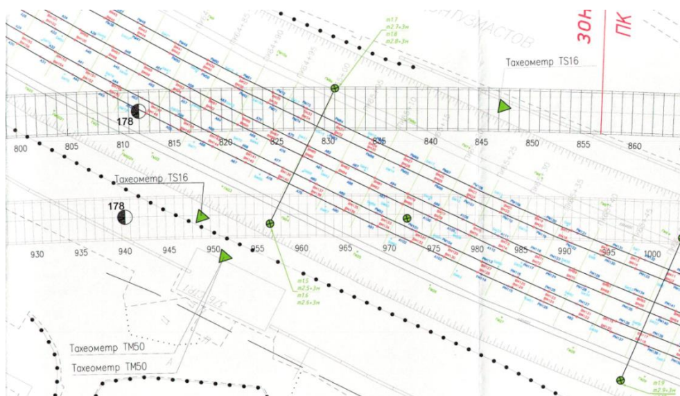
Рисунок 2.8 Схема расположения деформационных марок на одном из участков
