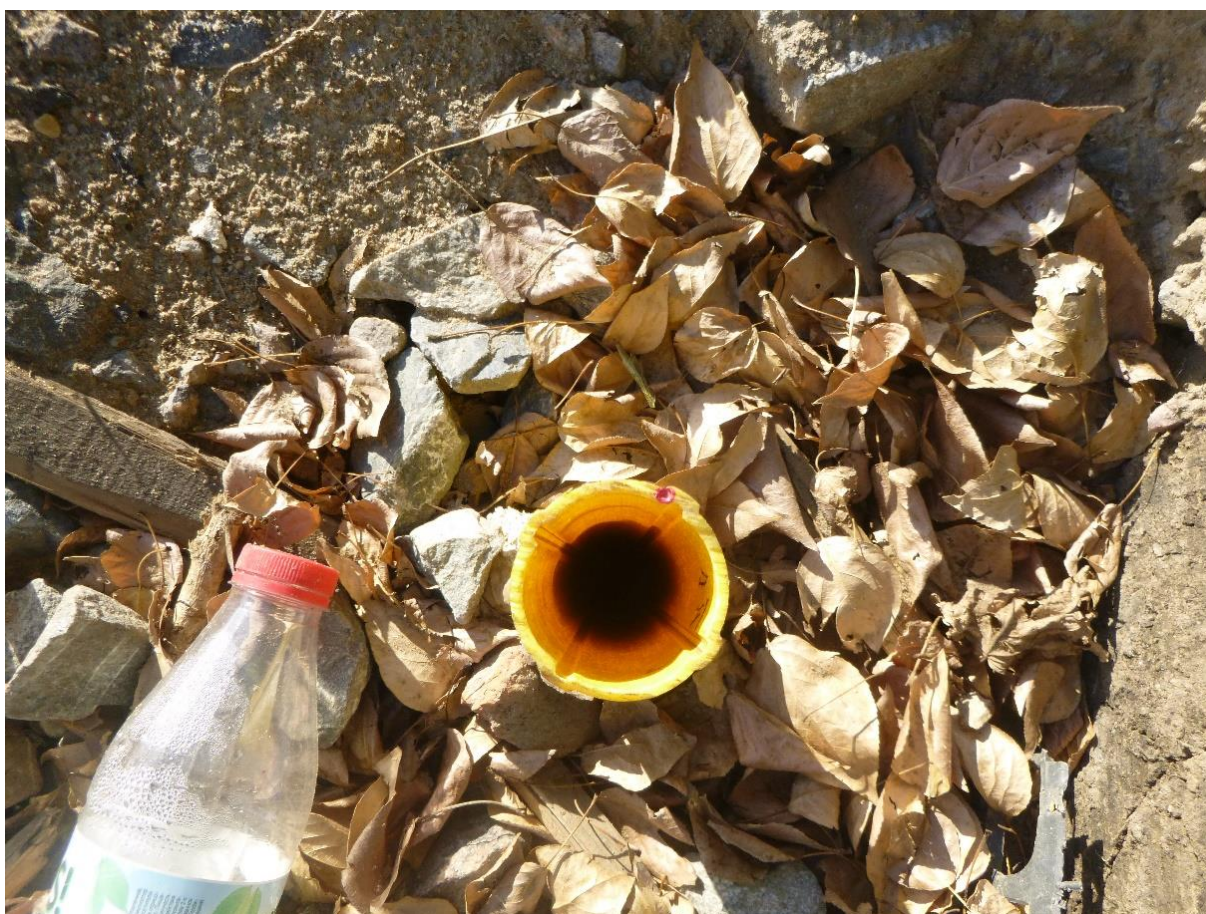
Рисунок 2.21 – Фотофиксация установленной наблюдательной скважина
