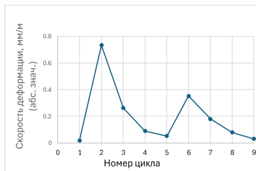
Рисунок 4.9 – Результаты анализа привлечённых данных, случай №2: a – горизонтальные деформации (мм), б – скорости горизонтальных деформаций (мм/м)
