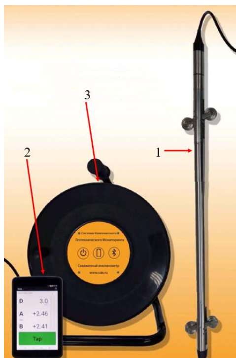
Рисунок 2.22 – Основные конструкции скважинного инклинометра. измерительный зонд – 1, блок сбора данных – 2 и соединяющий кабель с катушкой – 3
