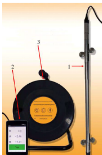
Рисунок 2 – Основные компоненты скважинного инклинометра: измерительный зонд – 1, блок сбора данных – 2 и соединяющий кабель с катушкой – 3
