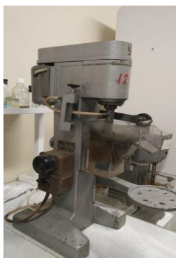
Рисунок 2.15 – Флотационная машина ФЛ – 137 с объемом камеры 500 см 3 и лабораторная механическая флотационная машина МЕХАНОБР с объемом камеры 3000 см 3
