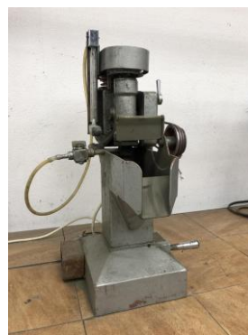
Рисунок 2.15 – Флотационная машина ФЛ – 137 с объемом камеры 500 см 3 и лабораторная механическая флотационная машина МЕХАНОБР с объемом камеры 3000 см 3
