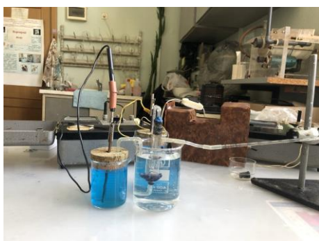
Рисунок 2.1 – Фото и принципиальная схема установки для измерения дзета-потенциала минеральных навесок методом «электроосмоса» (1 – 10% раствор \text{CuSO}_4 ; 2 – медный электрод; 3 – агар-агаровые ключи; 4 – минеральная навеска; 5 – источник постоянного тока; 6 – ячейка с встроенным градуированным капилляром; 7 – вольтметр; 8 – амперметр) [77]
