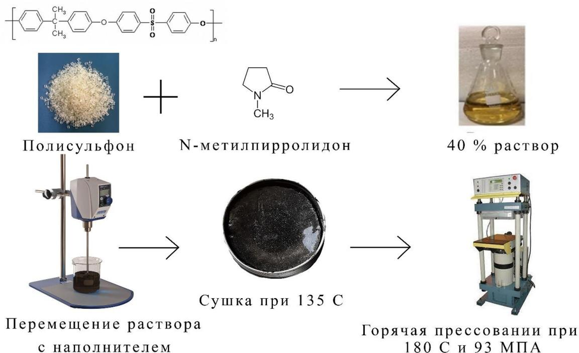
Рисунок 12. Схема приготовления раствора полимера и композитов на основе полисульфона
