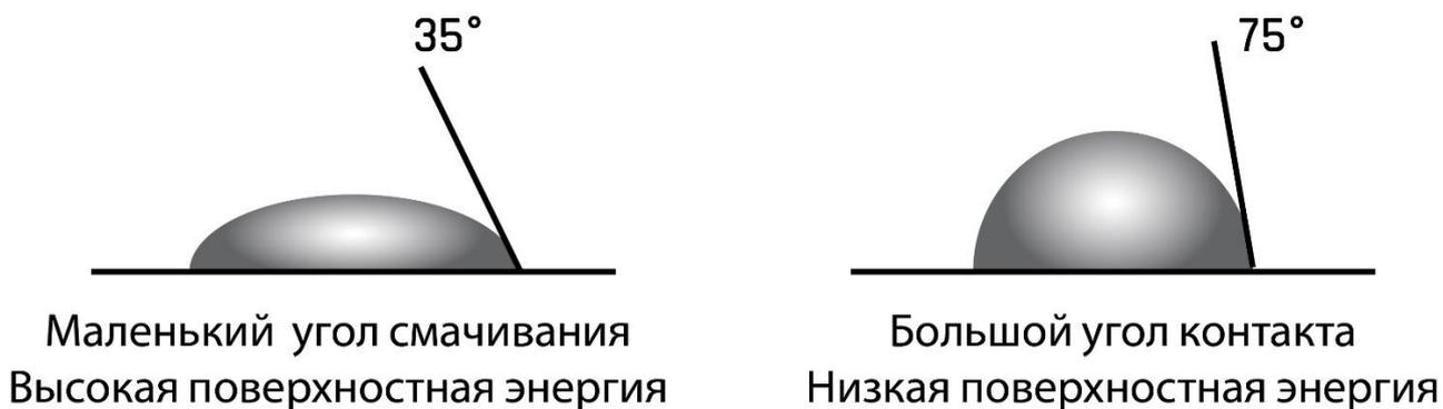
Рисунок 49. определение краевого угла смачивания капли воды с поверхностью композиционного материала.
