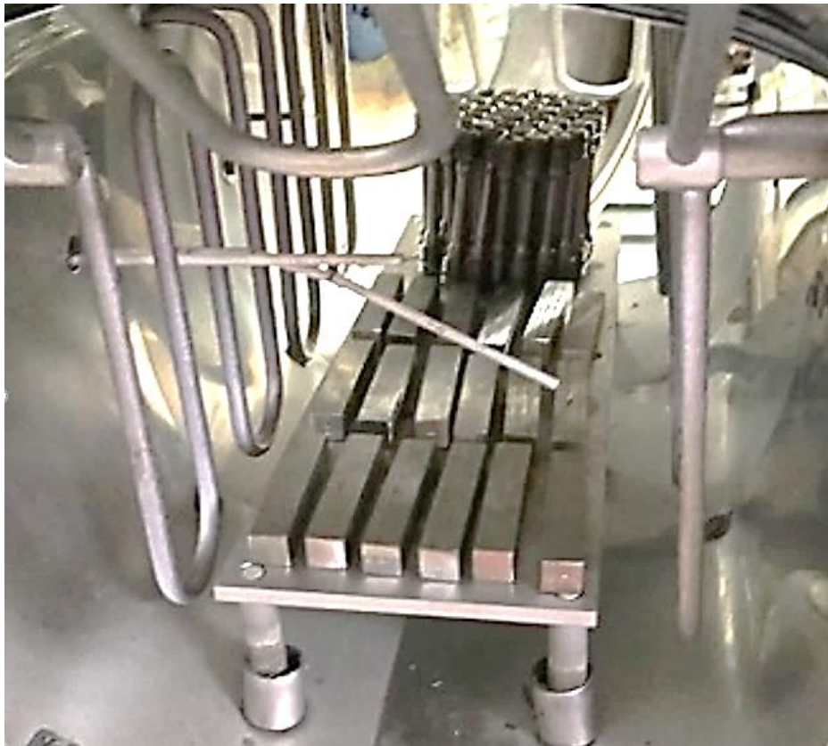
Рисунок 6 – Фотография образцов, загруженных в вакуумную печь для проведения термического воздействия
