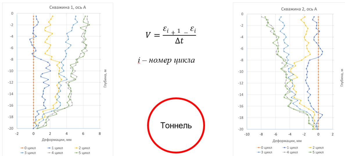
Рисунок 5 – Результаты скважинной инклинометрии (скважина №1 и скважина №2)
