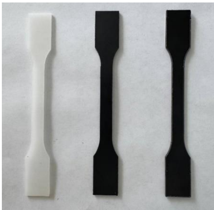
Рис. 5.2.2. Образцы из полипропилена с различным процентным содержанием УНТ
