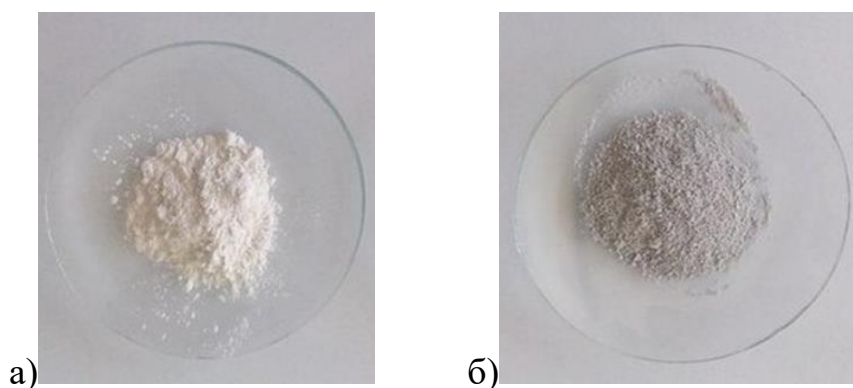
Рис. 4.1.2. Порошкообразный ПММА до процесса полимеризации: а) без УНТ; б) с УНТ 0,05 мас. %
