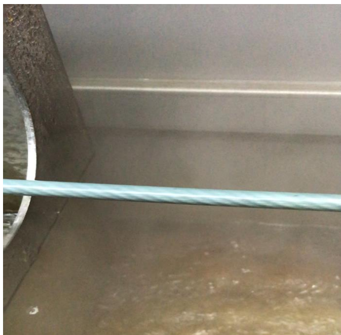
Рис. 4.2.6. Строительный канат из композитного материала «Полипропилен-УНТ»
