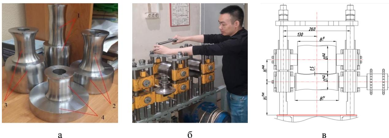
а – новые валки; б – процесс настройки ТЭСА 10–60; в – схема настройки клети
