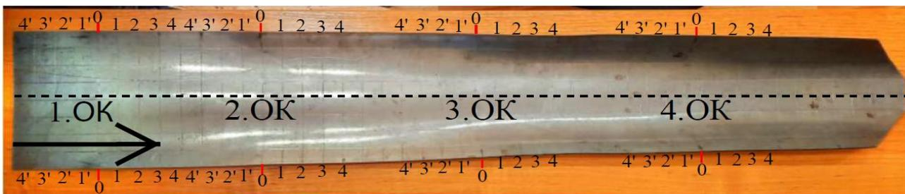
Рисунок 15 – Схема обработки торможки очага сворачивания ТЗ для трубы  $\text{Ø}50 \times 1,5$  мм
