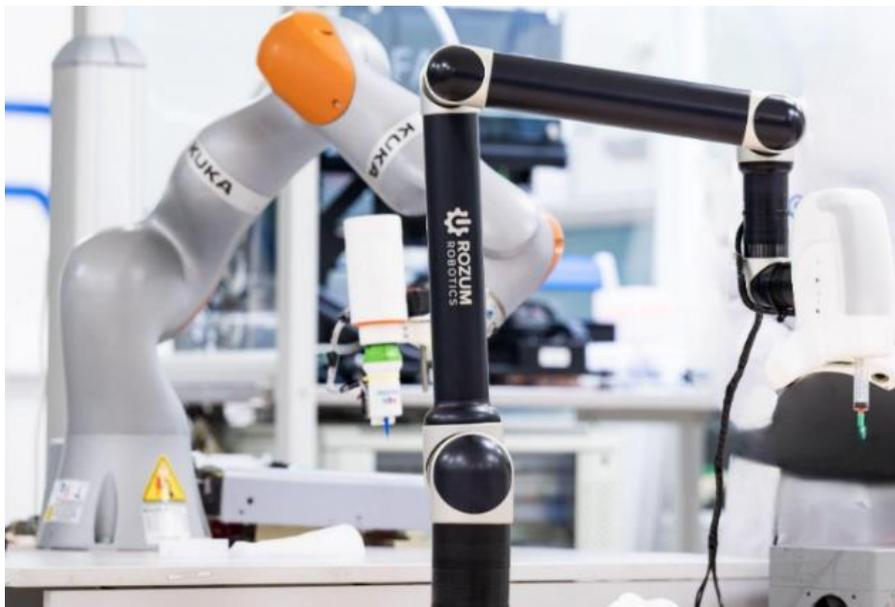
Рисунок 10 – Фотография программно-аппаратного комплекса на базе KUKA и на базе отечественного робота Rozum
