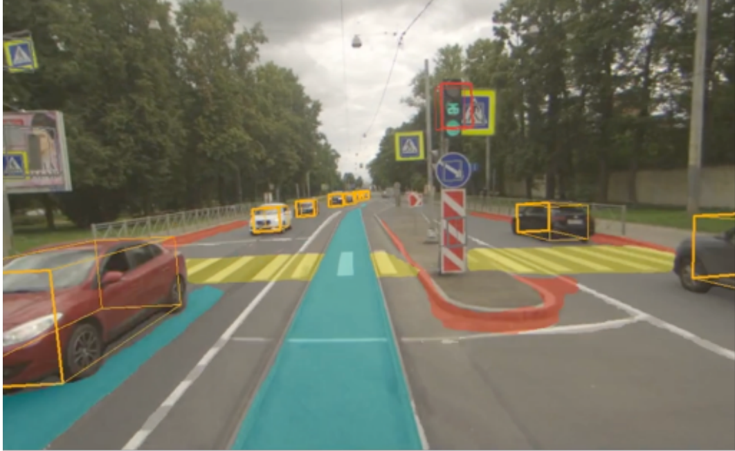
Рисунок 1.7 — Визуализация распознавания дорожной сцены (3D детекции – машины (желтые), светофоры (красные), область сегментации – бордюры (красная), трамвайное полотно (бирюзовое))
