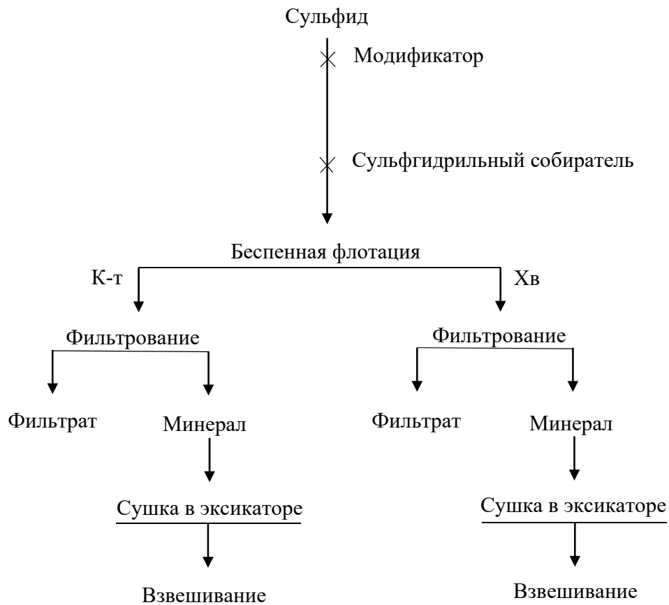
Рисунок 2.16 – Принципиальная схема комплексных исследований
