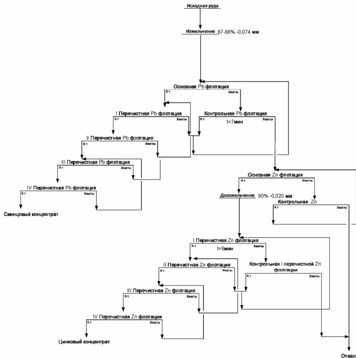
Рисунок 5.7 – Прямая селективная схема флотации свинцово-цинковой руды
