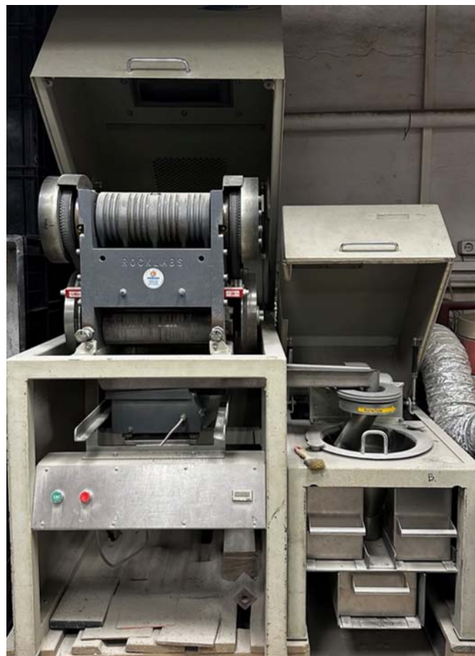
Рисунок 2.2 – Дробильная установка Rocklabs Ltd с сократителем RSD
