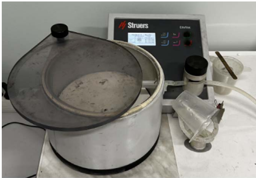
Рисунок 2.3 – Импрегнатор для удаления пузырьков воздуха при изготовлении брикетов Struers CitoVac
