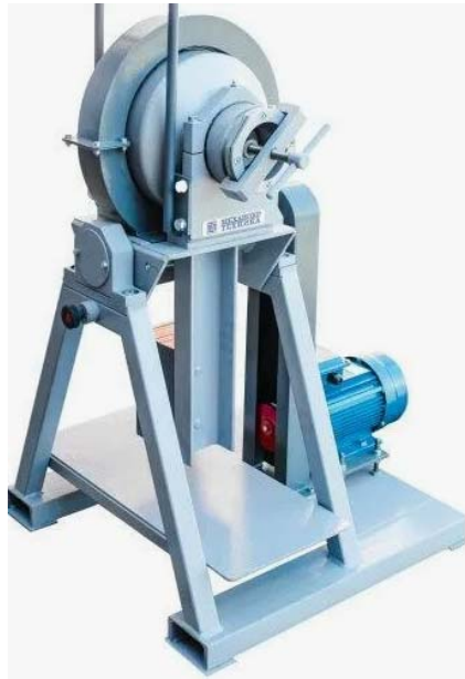
Рисунок 2.20 – Мельница шаровая лабораторная (МШЛ-7)
