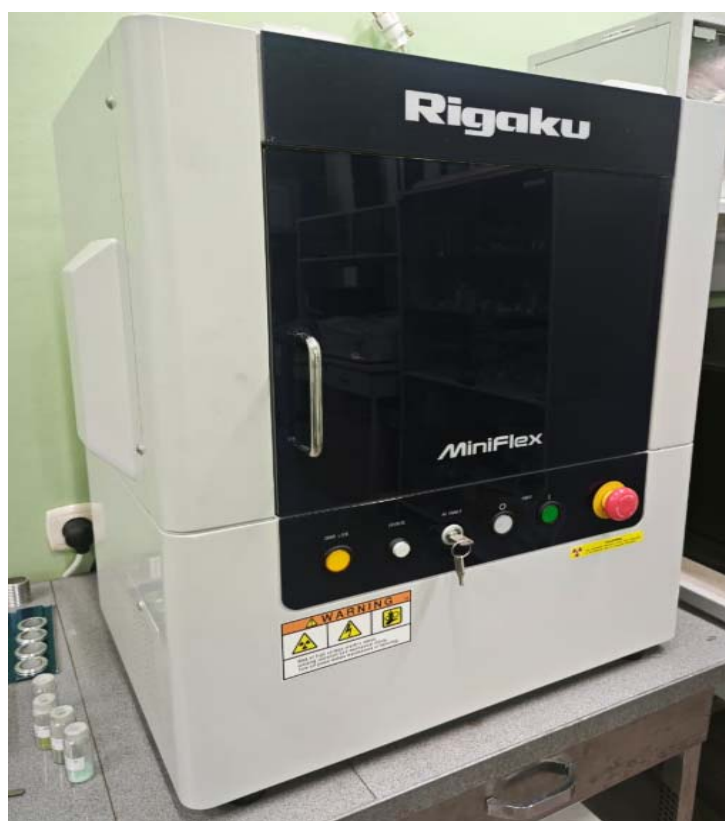
Рисунок 2.9 – Настольный рентгеновский дифрактометр Rigaku MiniFlex 600 (XRD)
