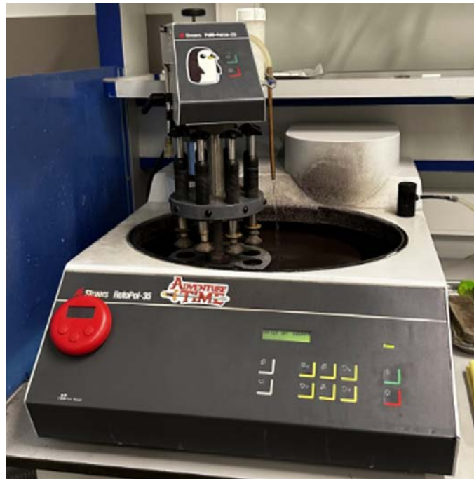
Рисунок 2.5 – Станок шлифовально-полировальный RotoPol 35, оснащенный держателем образцов PmdForce (производитель Struers)
