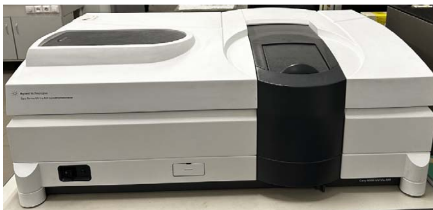
Рисунок 2.12 – УФ спектрометр UV-NIS Cary 6000i
