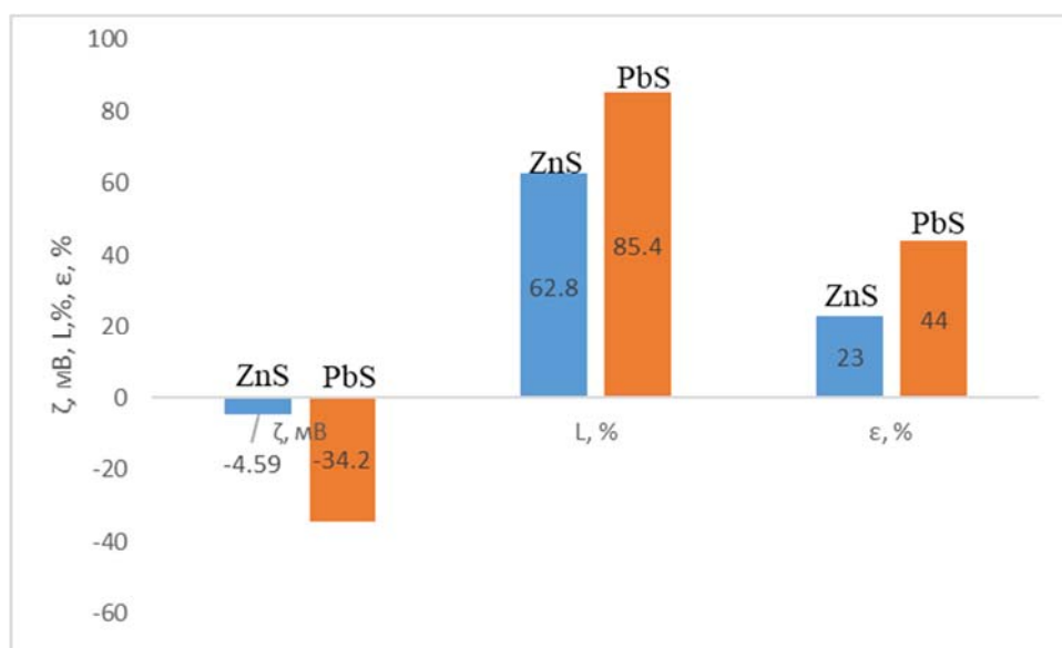
Рисунок 4.4 – Диаграмма извлечения в концентрат, относительной адсорбции БутКс-К в условиях флотации в трубке Халлимонта в сравнении с \zeta -потенциалом ультратонких частиц при \text{pH}_{\text{исх}} \text{NaOH} = 8,0
