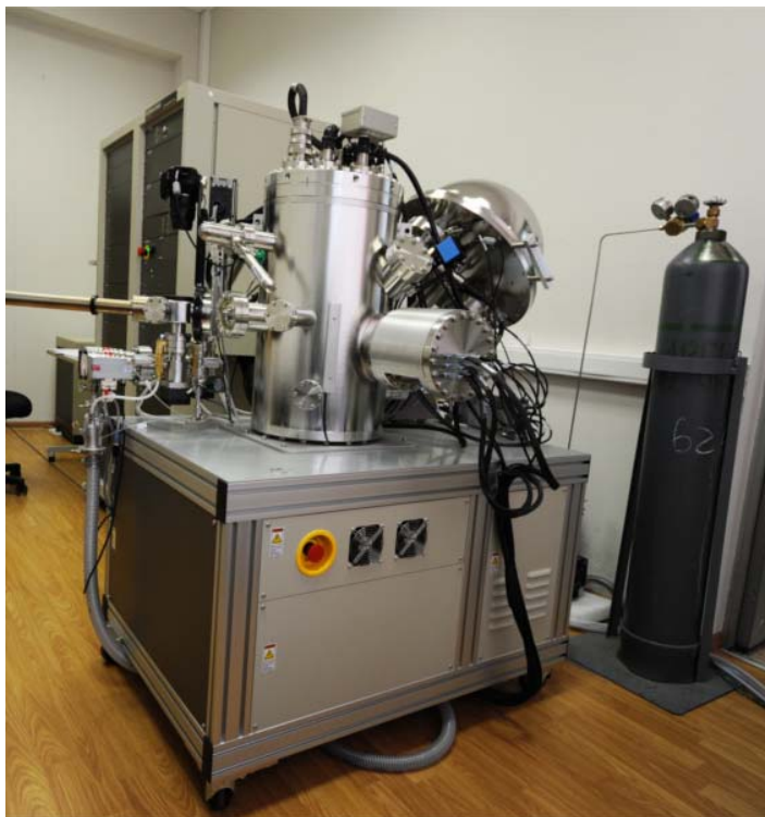
Рисунок 2.10 – рентгеновский фотоэлектронный спектрометр PHI5000VersaProbeII (ULVAC-PHI)
