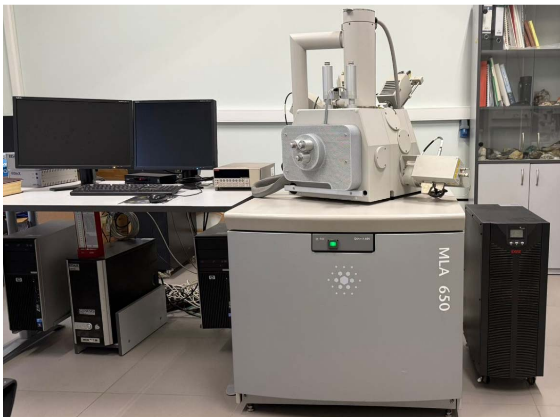
Рисунок 2.7 – автоматизированный минералогический комплекс MLA на базе сканирующего электронного микроскопа (SEM) FEI Quanta 650
