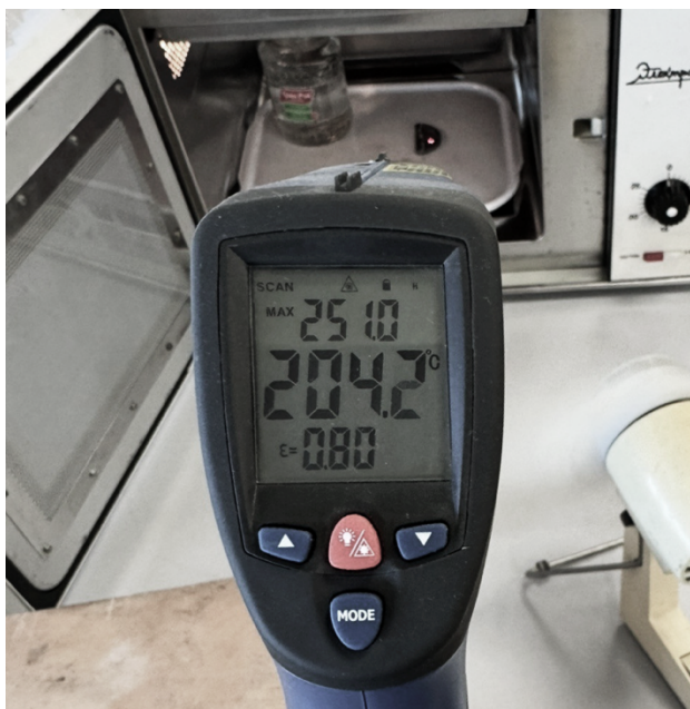
Рисунок 2.5 – Интерфейс пиромерта DT-8868H в момент замера температуры образца 5 после седьмой итерации нагрева
