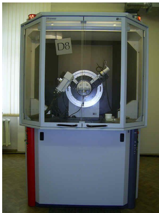
Рисунок 2.8 – Рентгеновский дифрактометр D8 Advance Bruker AXS (Германия)
