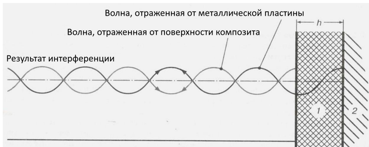
Рисунок 4.30 – Схема возникновения интерференционной картины при регистрации спектра отражения композита
