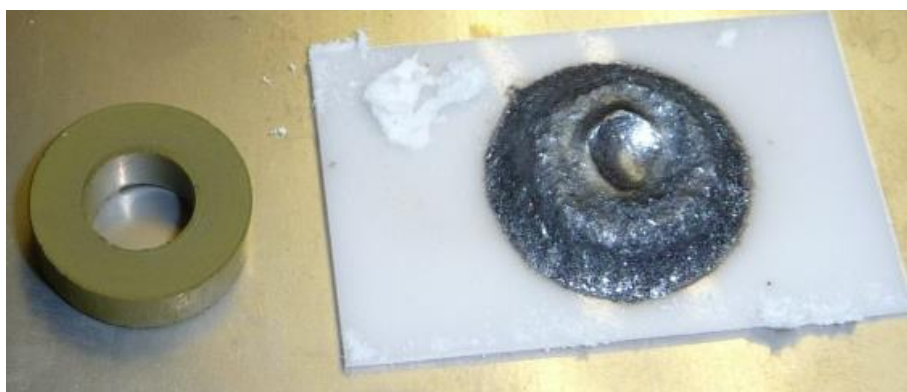
Рисунок 3.1 – Фотоснимки опытных заготовок Y_3Fe_5O_{12} для метода РТС: слева – сырой образец до РТС; справа – после РТС при T = 1500 \text{ °C} в теч. 5 мин [145]
