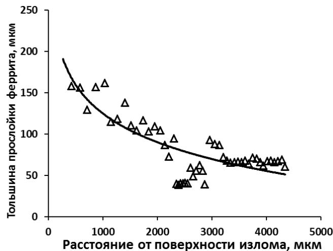
Рис. 4.20. Излом Z-образца на растяжение (а), его профиль (б) в вертикальном сечении и такие же профили в изломах продольных образцов на растяжение (в) и ударный изгиб (г), выделенными из 3D-моделей; сопутствующие растяжению Z-образца полосчатость в микроструктуре (д) и изменение толщины прослойки феррита при удалении от излома (е). Листовая сталь 09Г2С
