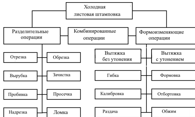
Рисунок 1.1 – Основные операции холодной листовой штамповки
