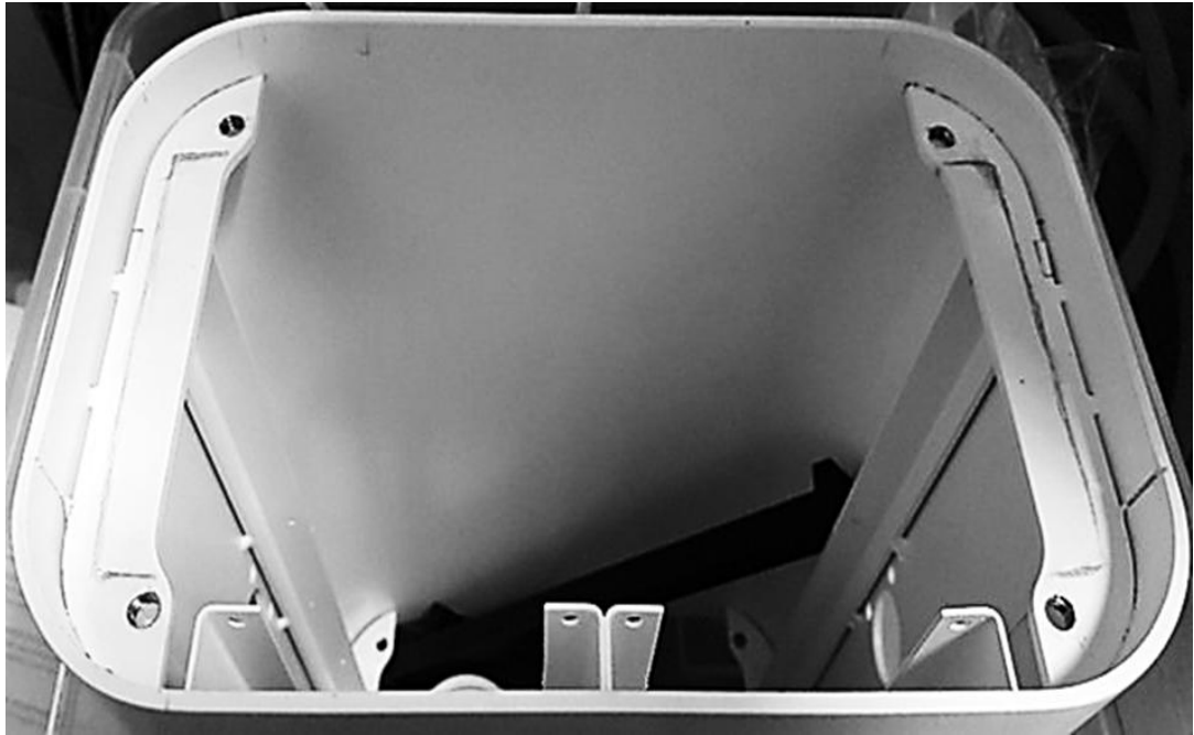
Рисунок 4.2 – Корпус устройства, выполненный из стального листа толщиной 4 мм с применением технологии пошаговой гибки и последующей обработкой поверхности
