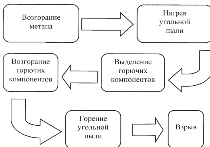
Рисунок 3.7 – Схема процессов возгорания с последующим взрывом
