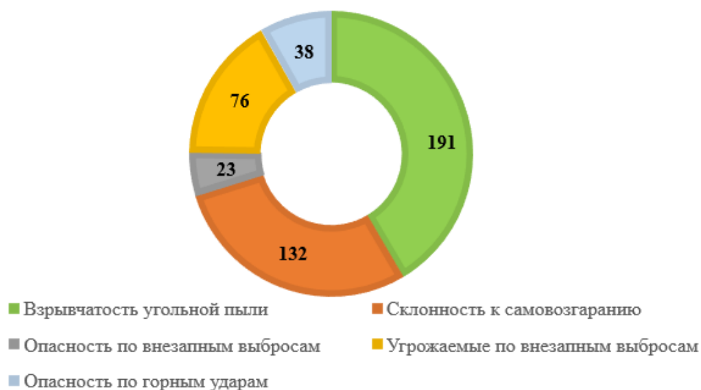
Рисунок 1.6 – Виды опасностей разрабатываемых шахтопластов
