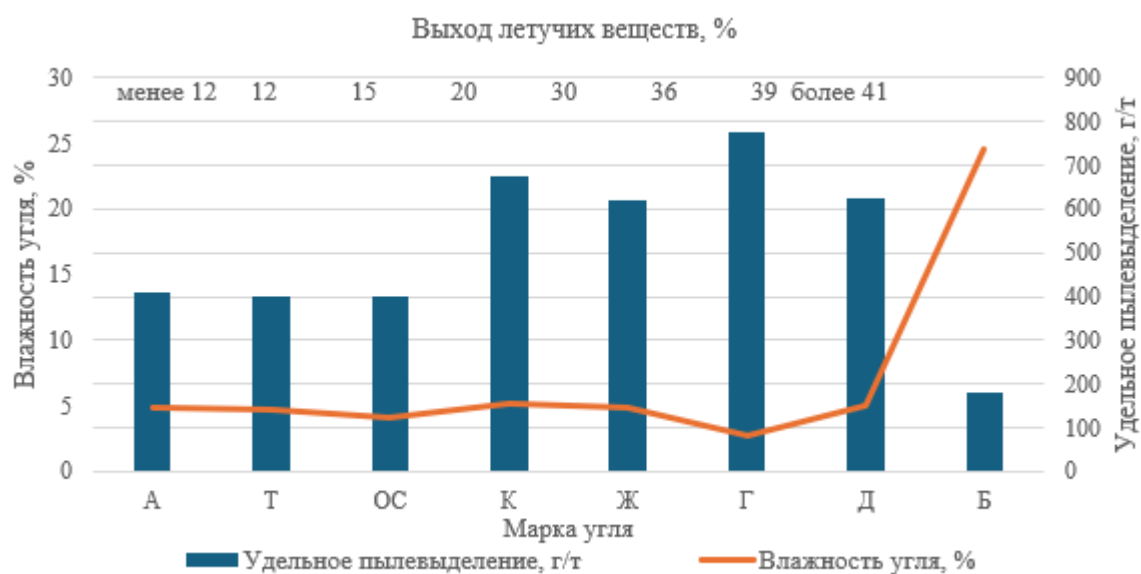
Рисунок 2.2 – Характеристики пылеобразующей способности угля в ряду его метаморфизма
