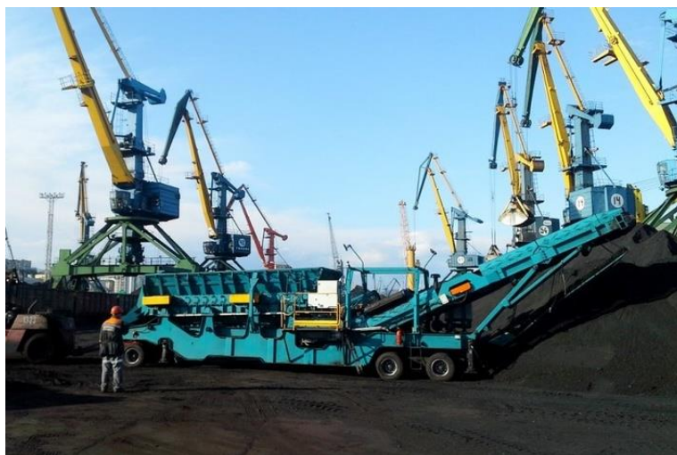
Рисунок 1.23 Операции по приведению угля в транспортабельное состояние на ДСК могут сопровождаться обильным пылением
