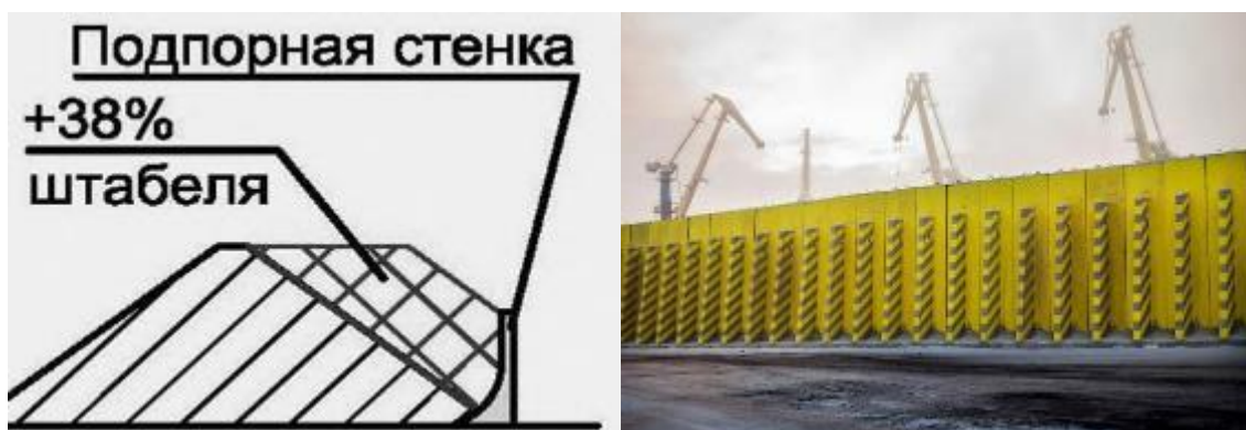
Рисунок 2.1 Подпорные стенки для штабелей угля на складе
