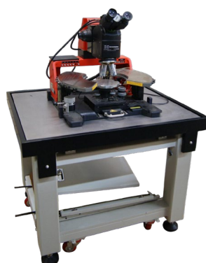
Рисунок 79 – Измерительная система Karl Suss PM-5
