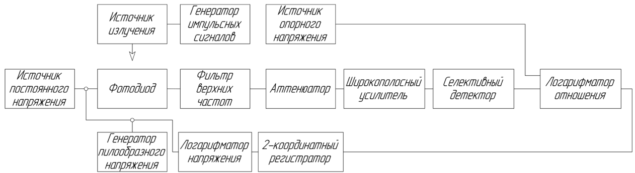
Рисунок 75 – Функциональная схема установки для характеристики параметров фоточувствительных элементов
