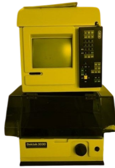
Рисунок 73 – Контактный профилометр Bruker Dektak 3030
