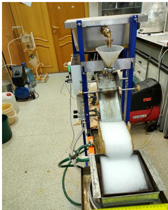
Рис. 2.8 - Изображение стендовой установки для исследований процесса пенной сепарация алмазосодержащего сырья
