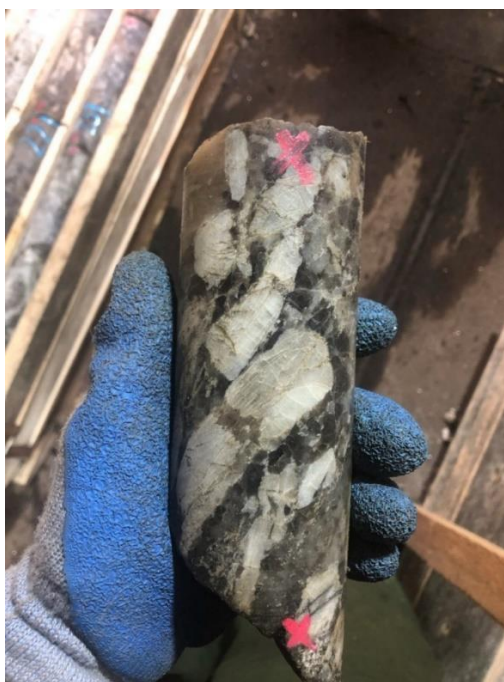
Рисунок 4.5 – Кварц-сподуменовый пегматит. Сподумен – блоки светло серого цвета
