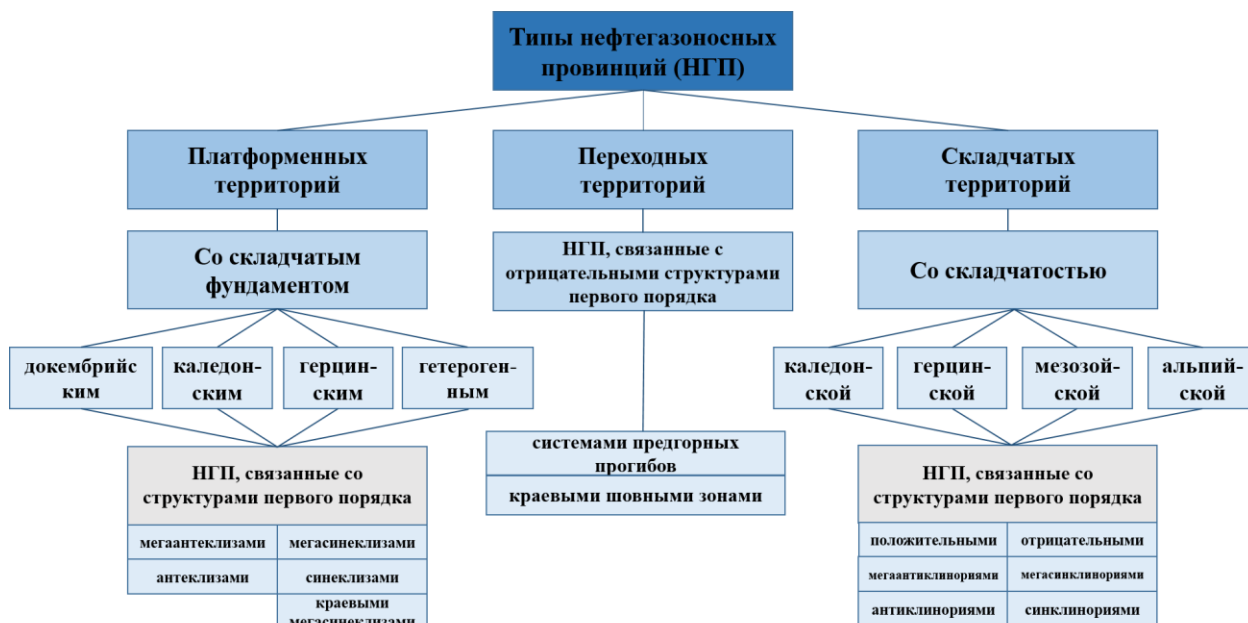
Рисунок 2 – Схема классификации нефтегазоносных провинций по приуроченности к тектоническим структурным элементам
