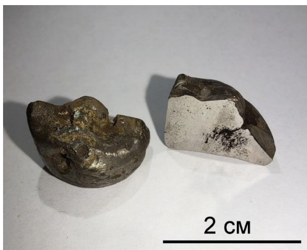
Рисунок 2.1 – Слиток состава \text{Mn}_{53}\text{Al}_{44}\text{V}_3 , полученный методом индукционной плавки
