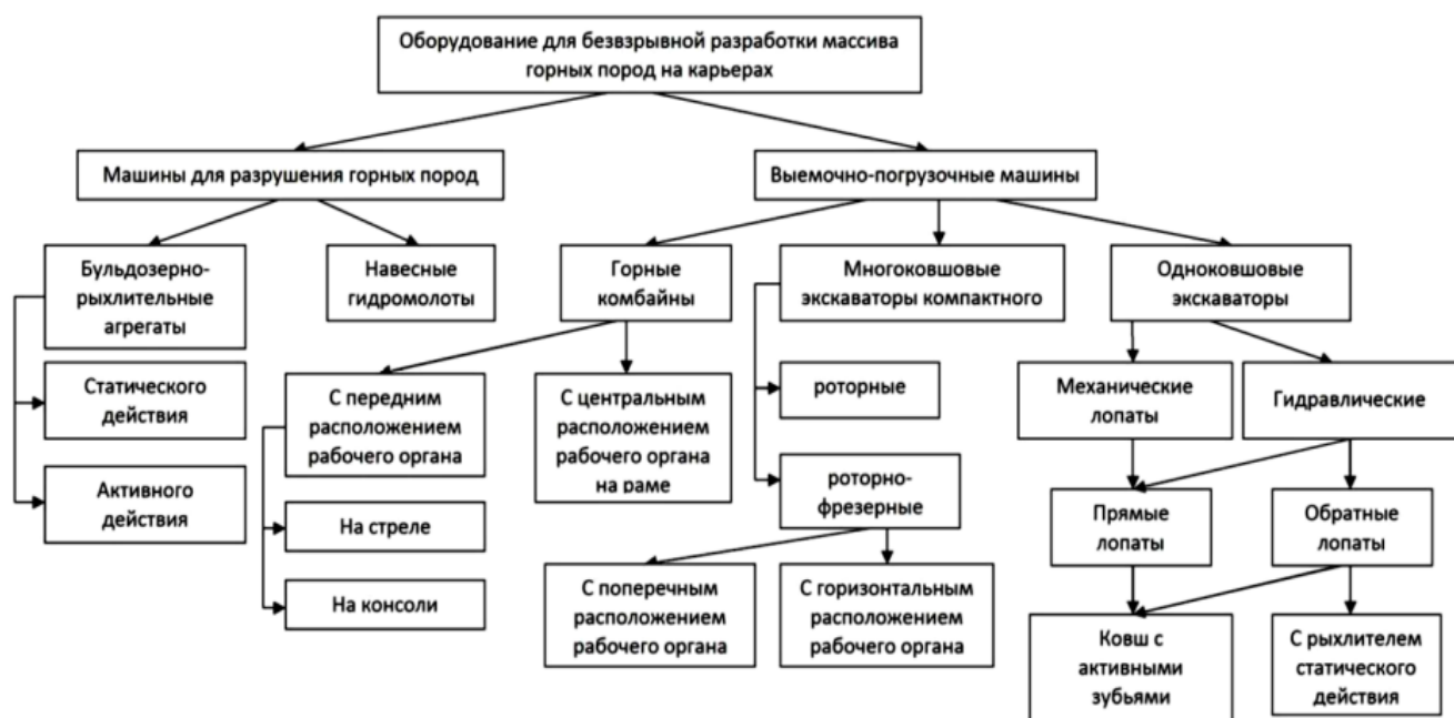
Рисунок 1.9 – Типы оборудования, применяемые для безвзрывной разработки массива горных пород на карьерах [68]
