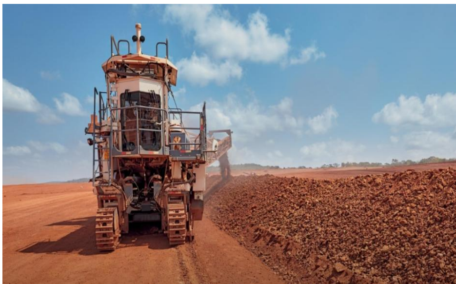
Рисунок 1.16 – Боковая отсыпка горной массы разгрузочным конвейером в штабель [83]
