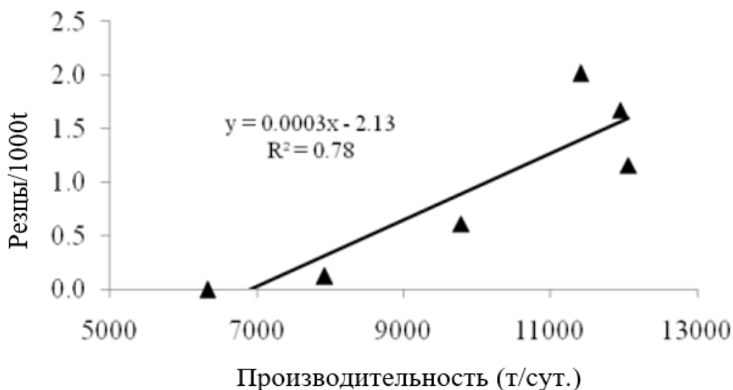
Рисунок 1.26 – Соотношение между суточной производительностью машины послойного фрезерования и износом резцов [92]
