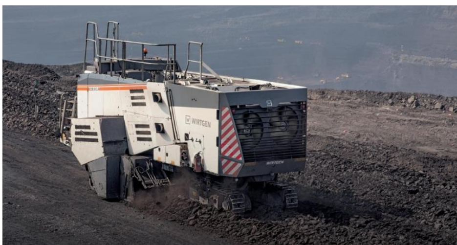
Рисунок 1.17 – Формирование штабеля из разрушенного материала по ходу движения комбайна [83]
