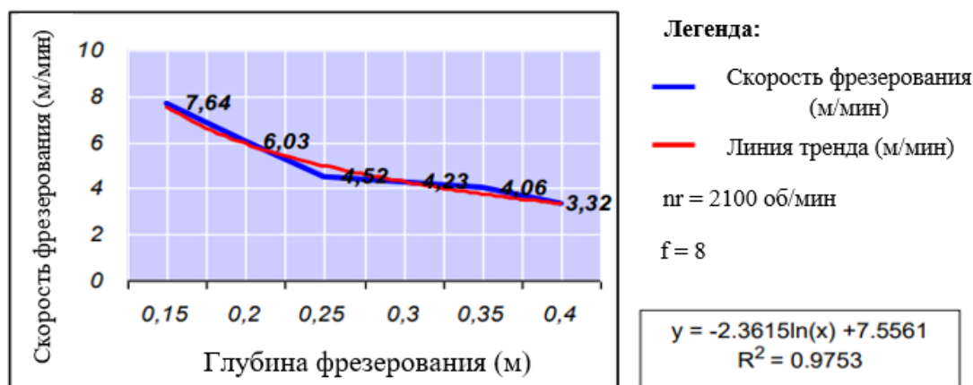
Рисунок 1.20 – Зависимости рабочей скорости машины послойного фрезерования от глубины фрезерования при крепости f=8 [89]
