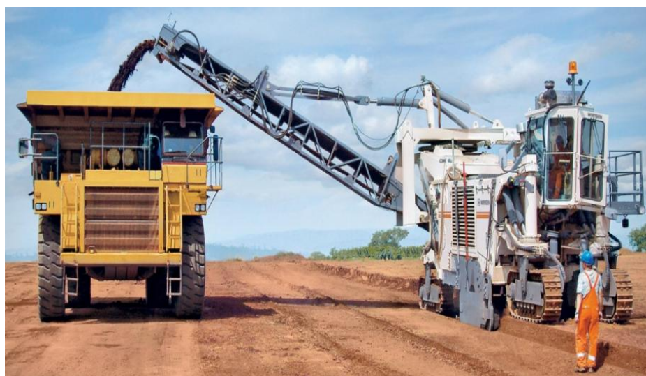
Рисунок 1.15 – Погрузка непосредственно в автосамосвалы [83]
