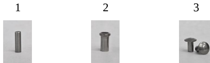
Рисунок 2 – Основные переходы при высадке заклепок
