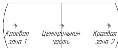
Рисунок 5 – Схема измерения микротвердости
